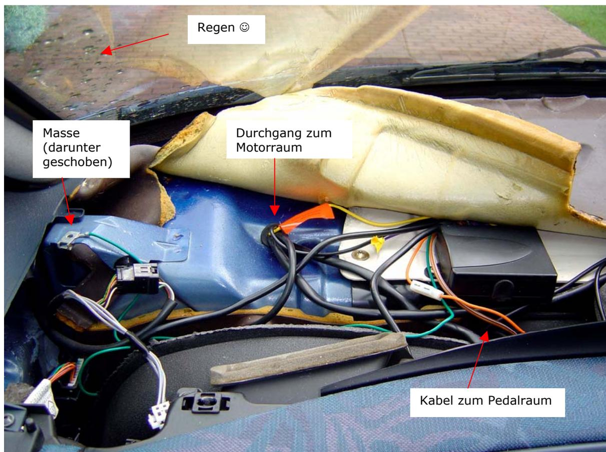
Das Steuergerät so nah wie möglich an den Instrumentenblock und so weit vor wie möglich auf der weißen Kunststoffplatte verschrauben. Sonst geht die Frontabdeckung nicht mehr drauf wegen dem Lüftungskanal.
