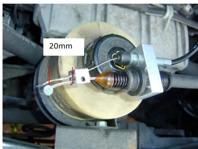
Zum Wiedereinhängen am besten den Gummischutzring zuerst in die Bohrung rasten und dann das Führungsteil wieder einschieben. Geht ganz leicht. Den Nippel mit einer Spitzzange wieder in den Gashebel einführen.
