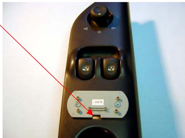
Dann die Platte wieder abmontieren und den Schalter vorsichtig zusammensetzen. Jetzt das Kabel durch die Öffnung ziehen und den Schalter von unten mit Beilagscheiben und Muttern endgültig verschrauben. Würde man die Grundplatte vorher festschrauben, formt sie sich dem Untergrund entsprechend an, welcher leicht gewölbt ist und der Schalter läßt sich nicht mehr zusammendrücken.
