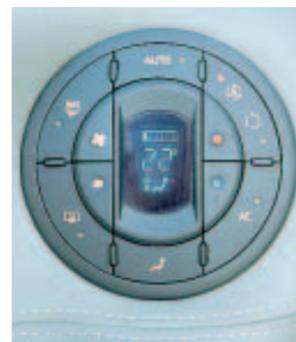
Anzeige- und Bedieneinheit der Klimaanlage in der Fahrertüre.
